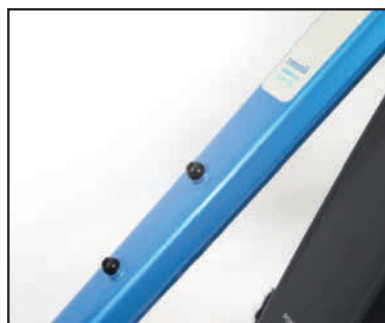
Beim Trapez-Rahmen kann der Flaschenhalter auf dem Oberrohr montiert werden.
