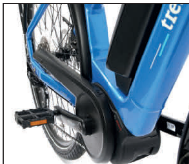
Der Motor liegt tief und sorgt für einen ausgewogenen Schwerpunkt.
